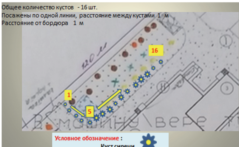
Рис. 1. Схема расположения сиреновой аллеи
